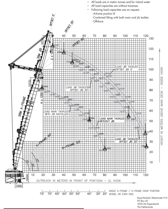
GUIDELINE CAPACITY DIAGRAM -A-FRAME IN POSITION I
