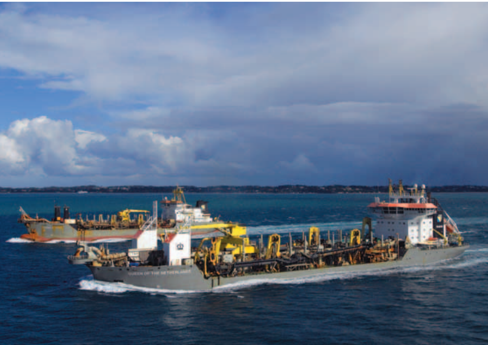
De sleehopperzuigers Queen of the Netherlands en Cornelis Zanen op het Melbourne project in Australië.
