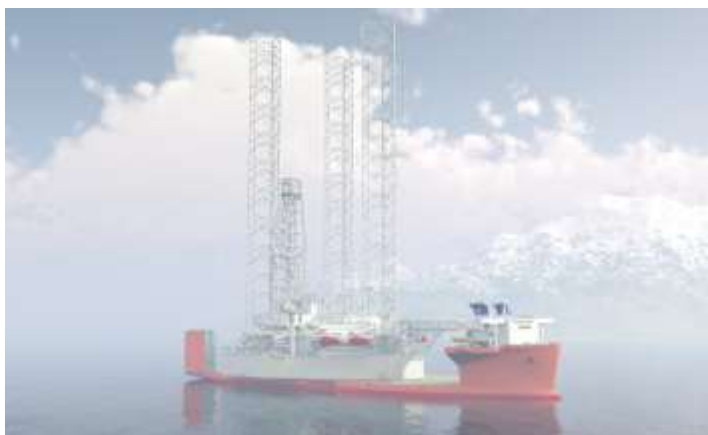
Impressie van de M/V White Marlin die een Cat-J jack-up platform vervoert Klik hier voor het downloaden van een impressie met een hoge resolutie
